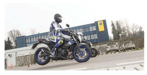
paré, sur la base de mesures objectives, les décélérations de motos avec et sans ABS. Dans ce test, 4 pilotes ont effectué successivement 6 freinages à fond à bord de 2 Yamaha XJ6-N – une avec et une sans ABS – sur chaussée sèche à 60 km/h et sur route mouillée à 30 km/h.
