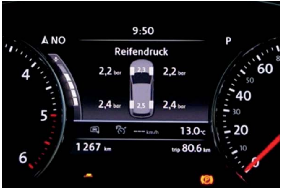
Exemple d'un système SSPP direct affiché sur la planche de bord.
